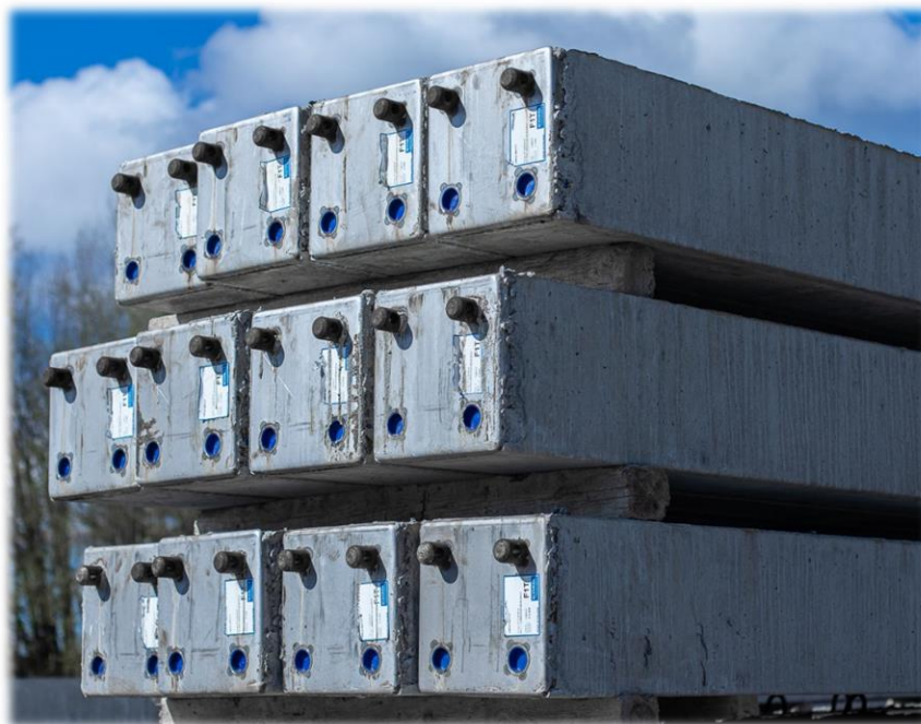
Kuva 2. Jatkoksia valettuna betonipaaluissa
